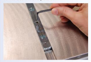
Le jeu présent entre la barre du guide à onglets Delta et la rainure du banc de scie s'élimine en «élargissant» la barre au moyen d'une clé hexagonale. Le guide Osborne EB-3 et le Delta partagent le même concept d'ajustement.
