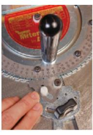
Le vernier escamotable permet quant à lui de régler des angles intermédiaires avec une précision de 0,1°.
