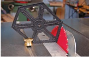
Le gabarit Poly-Gauge représente un moyen aussi fiable qu'économique de régler le guide à onglets ou l'inclinaison de la lame
