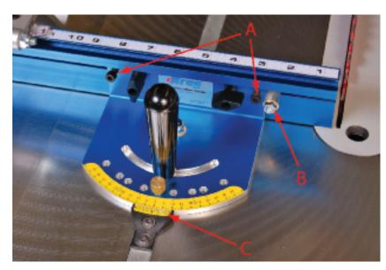
L'ajustement de l'équerrage du guide Kreg est facile grâce aux deux vis (A) situées de part et d'autre du guide. Une butée (B) permet de repositionner le guide toujours à la même distance de la lame. Quant au vernier (C), il permet de régler l'angle de coupe à 0,1° près.
