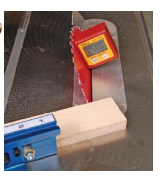
En associant un guide à onglets de précision et un inclinomètre numérique, le réglage des angles de coupe se fait en un rien de temps. Dans le cas de projets comportant des angles composés, il s'agit de la combinaison idéale.
