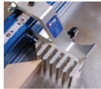
L'accessoire Perfect Miter, qui est offert en option, s'installe au besoin sur la butée standard du guide et évite d'endommager la pointe fragile d'une pièce coupée en angle.
