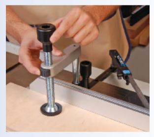
La serre à dégagement rapide dont est pourvu le guide Delta maintien solidement la pièce et aide à réduire l'effet de torsion qu'une longue pièce peut avoir sur le guide.
